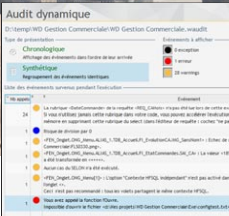
Ici on voit la mémoire occupée par une requête non libérée. L'audit dynamique visualise chaque module chargé en mémoire (avec sa taille), signale également les warnings d'exécution, les erreurs non fatales et les asserts (programmation défensive)
